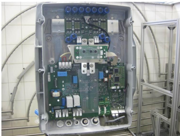
Bild 3: Prüfling nach der Staubprüfung, exemplarisch
