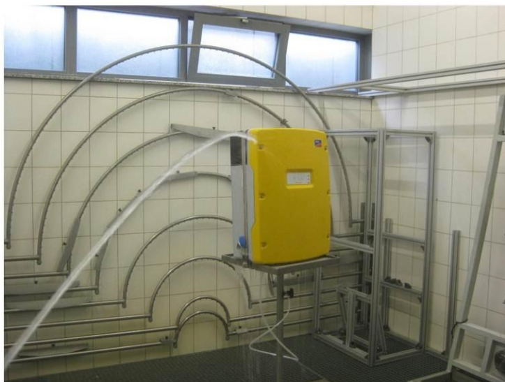
Bild 5: Prüfaufbau IP X5
