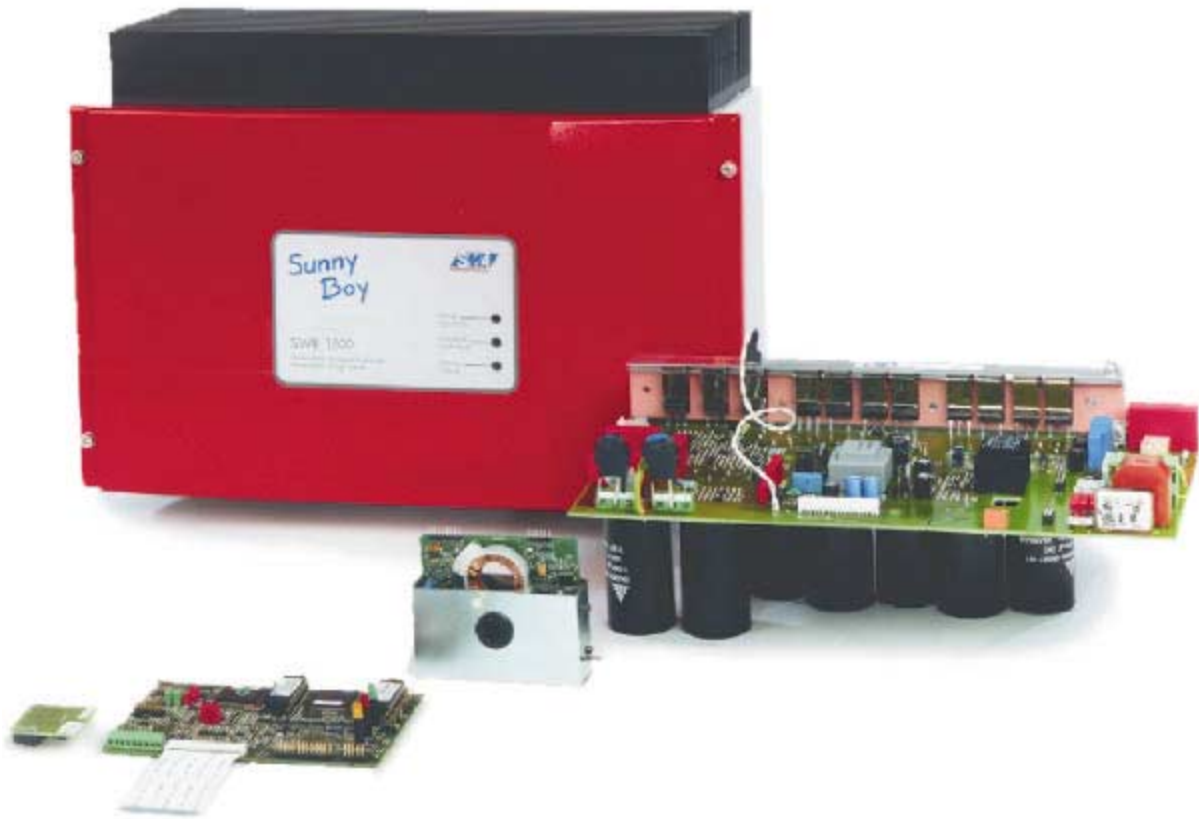
Abb. 4: Ende 1996, der erste transformatorlose String-WR (Sunny Boy 1500) mit integriertem allstromsensitiven Fehlerstromschutzschalter
