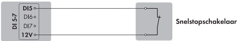
Afbeelding 12: Aansluiting van een schakelaar voor de snelstop op de digitale ingang DI 5 van de Sunny Tripower die als System Manager moet worden geconfigureerd
