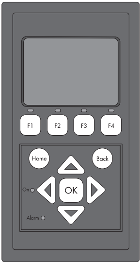
Figura28: Panoramica dei pulsanti del display e relative funzioni
