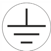
Figura23: Simbolo del conduttore di protezione
