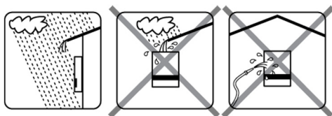
Figura4: Evitare un contatto continuo con acqua
