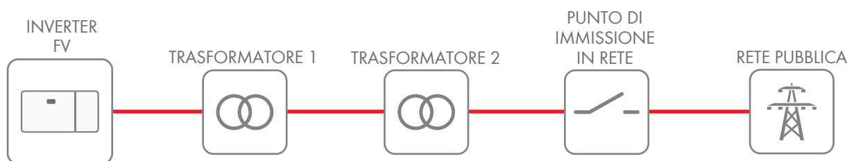
Figura 1: Impianto fotovoltaico collegato alla rete tramite diversi trasformatori
