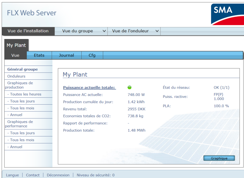
Illustration 3.20 État global de l'installation
