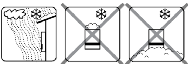
Illustration 2.4 Prévoir une circulation d'air adéquate
