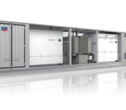
江蘇蘇美達集團，向越南得農省的 54MW 太陽能電廠提供系統解決方案。SMA 為該專案交付了 9 台 6000SC (MVPS-6000-20) 箱式中壓逆變一體機，每台系統內均配有兩台 Sunny Central 3000SC-EV 集中式變流器及用於電網連接的中壓變壓器解決方案。
