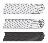
Figura 24: Cavo con conduttori diversi (dall'alto verso il basso): a corda rotonda, flessibili o flessibilissimi
