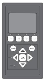
Abbildung 32: Display mit Steuer- und Funktionstasten
