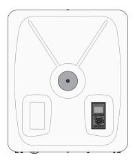
Figura 2: Inverter con coperchio dell'involucro singolo Il coperchio dell'involucro singolo è fissato con una vite a un telaio intermedio sottostante con traversa. La traversa stabilizza il collegamento tra la custodia, il telaio intermedio e il coperchio dell'involucro.
