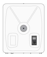
Imagen 2: Inversor con tapa de la carcasa de una pieza La tapa de la carcasa de una pieza está fijada con un tornillo a un marco intermedio inferior con un travesaño. El travesaño estabiliza la conexión entre carcasa, marco intermedio y tapa de la carcasa.
