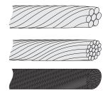
Figura 31: Cavo con conduttori diversi (dall'alto verso il basso): a corda rotonda, flessibili o flessibilissimi
