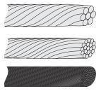
Figure 30 : Câbles aux conducteurs différents (du haut vers le bas) : monobrin, multibrins, à fils fins et à fils extrafins
