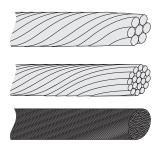
Abbildung 24: Kabel mit verschiedenen Leitern (von oben nach unten): mehrdrähtig, feindrähtig und feinstdrähtig
