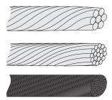
Imagen 24: Cables con diferentes tipos de conductores (de arriba abajo): de varios hilos, de hilo fino y de microhilo
