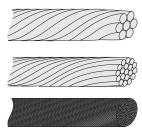
Abbildung 31: Kabel mit verschiedenen Leitern (von oben nach unten): mehrdrähtig, feindrähtig und feinstdrähtig
