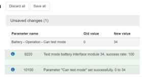
✓ Wenn die CAN-Schnittstellen BAT3 und BAT4 fehlerfrei sind, wird im Menü Ereignisse die Erfolgsrate mit 100 angegeben: success rate: 100
