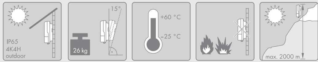
**C** Wechselrichter montieren | Mounting the Inverter | Εγκατάσταση του μετατροπέα | Montaje del inversor | Montage de l'onduleur | Montaggio dell'inverter | Montáž střídače | Montering af omformeren | Omvormer monteren | Montaż falownika | Montar o inversor | Az inverter felszerelése
