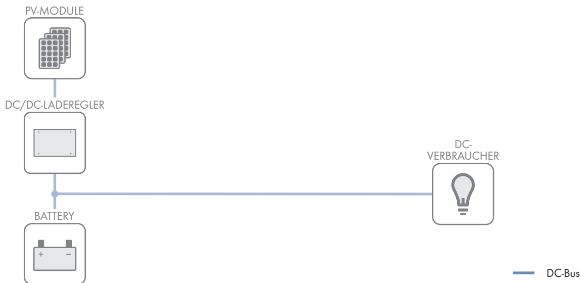
Abbildung 2: Beispiel eines DC-gekoppelten Systems
