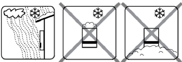
Ilustración 2.4 Asegúrese de que exista suficiente ventilación
