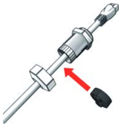
Illustration 2.21 Acheminer les câbles dans les presse-étoupe
