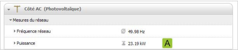
Figure 2: Somme de la puissance des onduleurs lorsque la vue de l'installation est sélectionnée (exemple) Selon le type de valeur, un récapitulatif pour le groupe d'appareils s'affiche.
